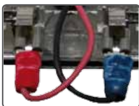
Bild: Kontaktierungsstelle der Rückleuchte
